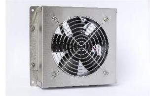
Dieser Ventilator befördert, Luft aus dem Aufzugsschacht in den Fahrkorb. Bei Stromausfall ist durch die die akkugepufferten Spannungsversorgung ein weiterer Betrieb von min. 2 Std. sichergestellt.
